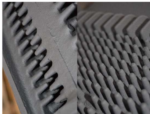
Рисунок 1. Внешний вид поверхностей теплообменника
