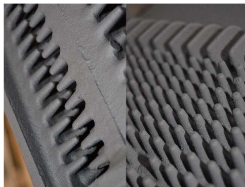
Рисунок 1. Внешний вид поверхностей теплообменника
