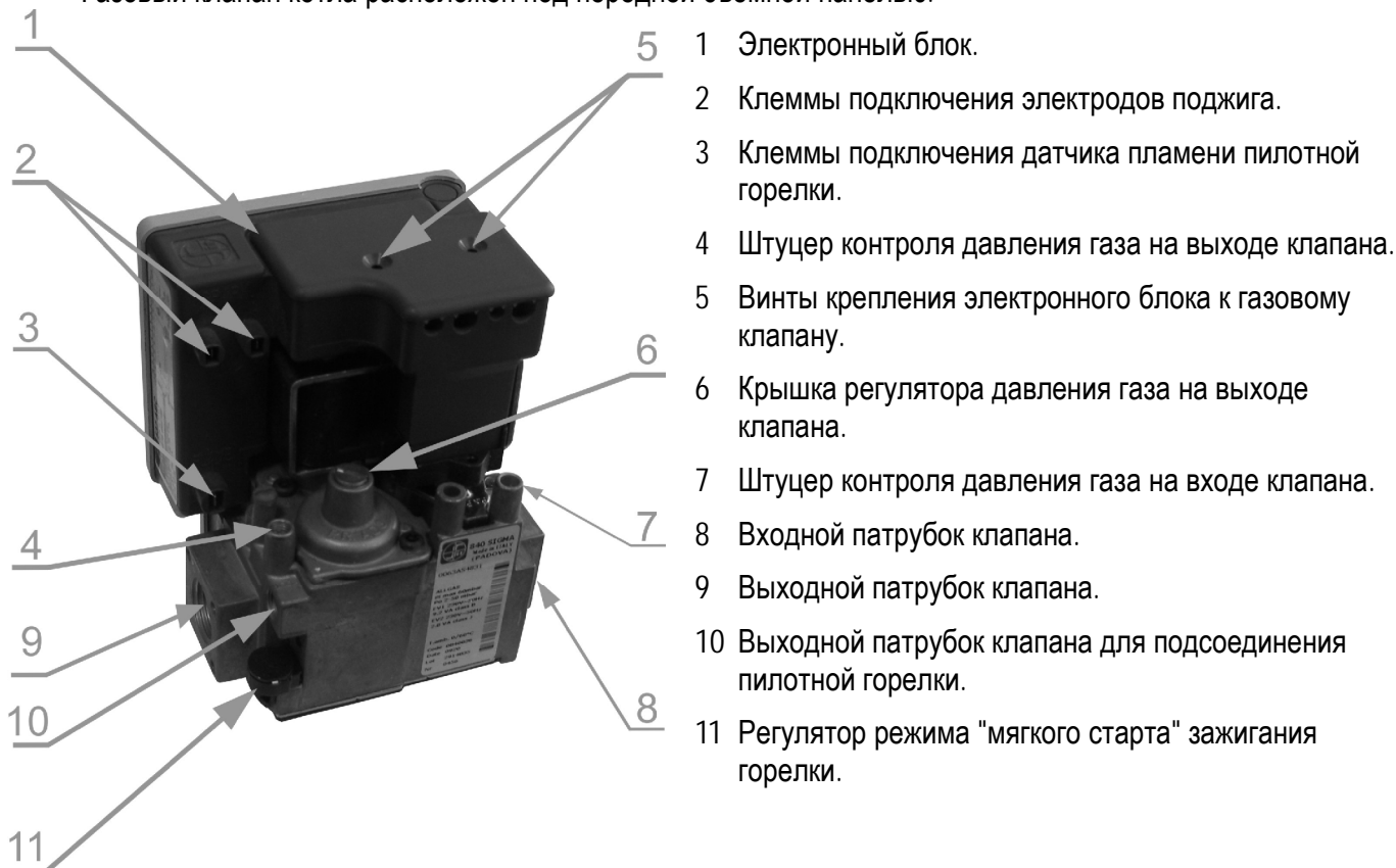
Рисунок 10. Газовый клапан котла с автоматикой.
